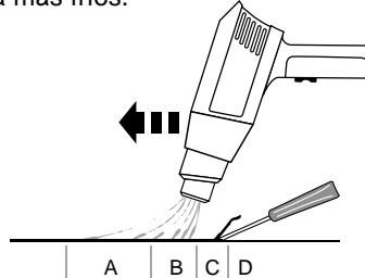
**Nota:** No utilice la pistola térmica sobre superficies que se puedan dañar con el calor, como paneles revestidos con vinilo, chapas de paredes y marcos de ventanas.
