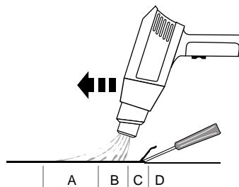
**Nota:** Ne pas utiliser le pistolet sur des surfaces susceptibles de s'endommager par la chaleur, comme les panneaux, les parements et les cadres de fenêtres recouverts de vinyle.
